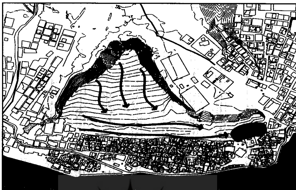
شکل شماره ۱۰ - جهت حرکت آب‌های سطحی به سمت مجموعه چاه‌های طلا
