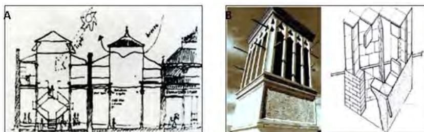
تصویر ۱- A: ارتفاع بلند فضای داخلی و پنجره کوچک در قسمت بالای دیوار جهت تهویه و B: استفاده از بادگیر (El-Borombaly & Molina-Prieto, 2015)
