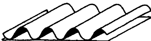
شکل ۳۰ - مقوای دو جداره تاشونده دارای پنج لایه است
