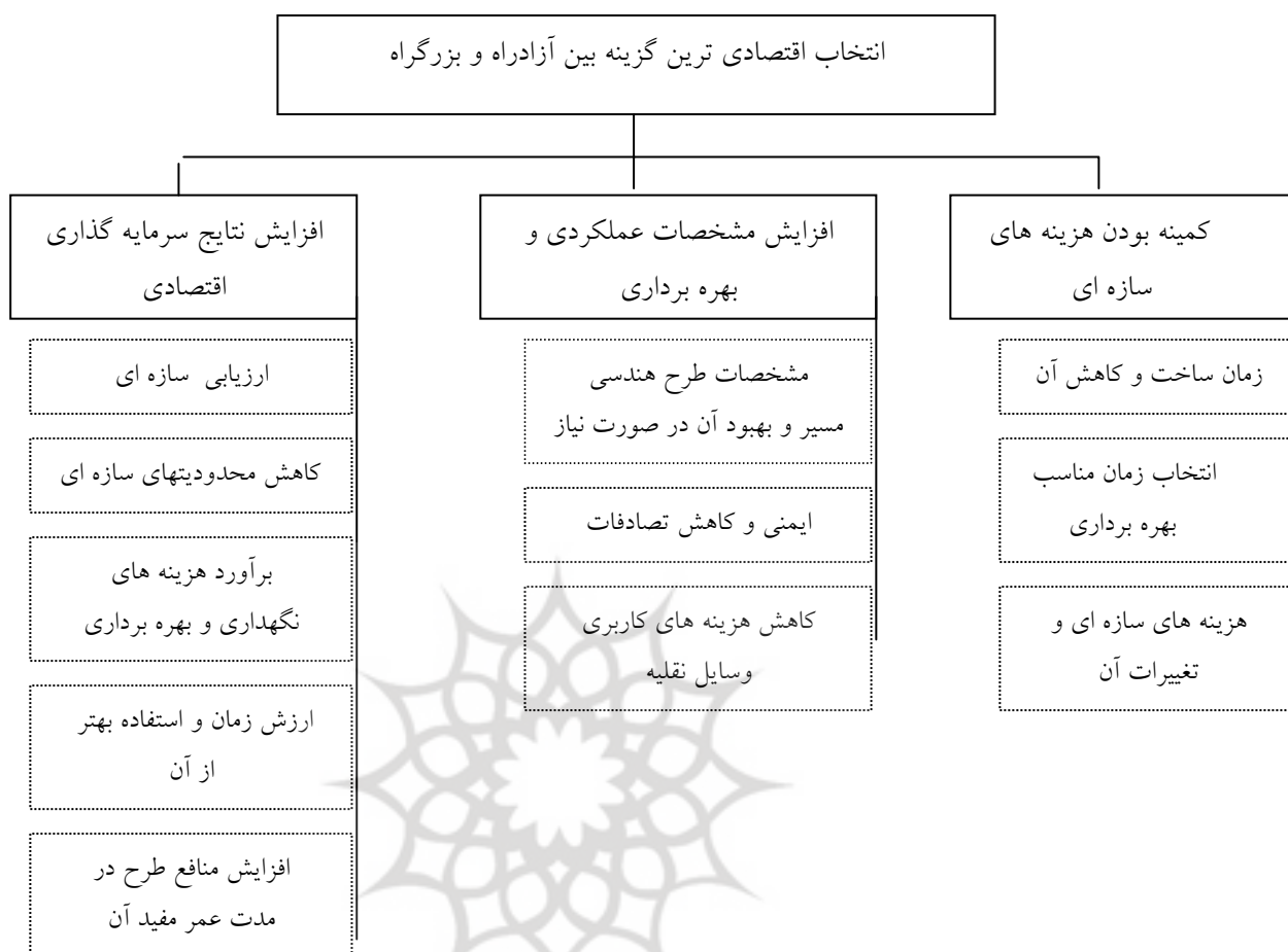
شکل 1. اهداف الگوی ارزیابی فنی - اقتصادی احداث و بهره برداری آزادراه و بزرگراه
