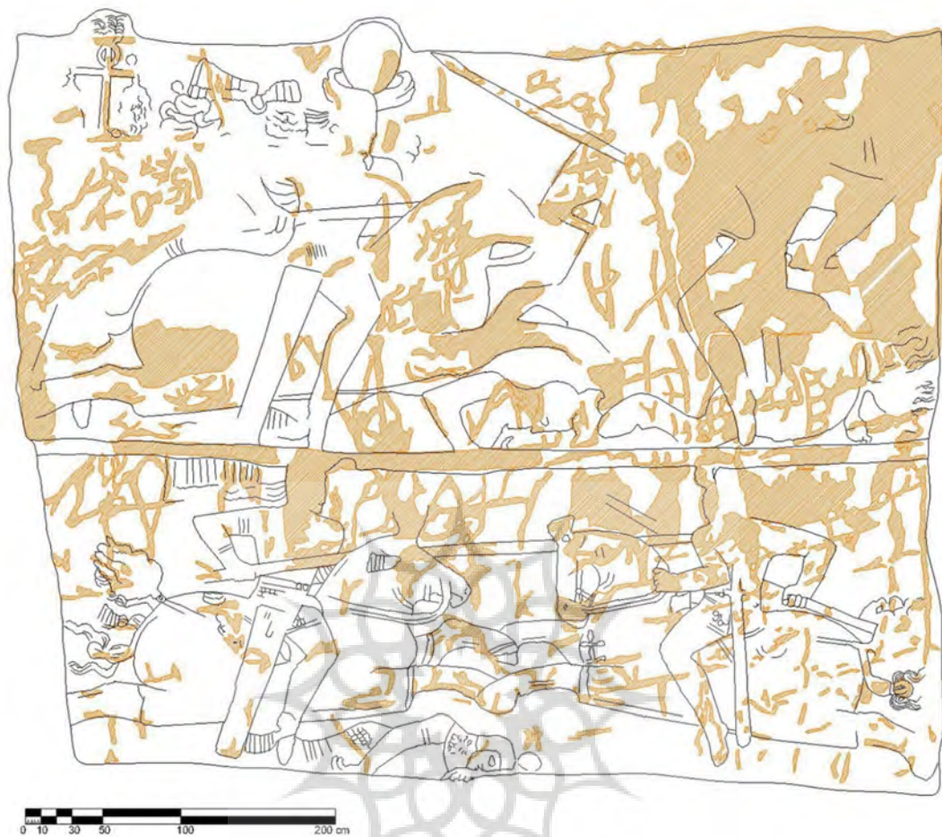
لايه لايه شدن جدا شدن فيزيكي لايه هاي سنگ موزاي يا سطح سنگ
