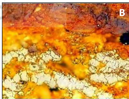
تصویر ۶ A: تصویر قسمتی از نمونه ۶ در ناحیه نمونه‌برداری شده؛ B: تصویر میکروسکوپ نوری از توزیع رنگ‌های نارنجی - زرد تیره و قهوه‌ای لایه‌های اکسیدی در نمونه ۶ (مأخذ: نگارندگان، ۱۳۸۷).
