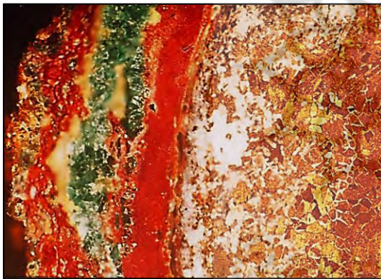
تصویر ۵. تصویر میکروسکوپ نوری از ترسیب ترکیبات اکسیدی قلع در مرزخانه‌های نمونه ۵ (مأخذ: نگارندگان، ۱۳۸۹).
