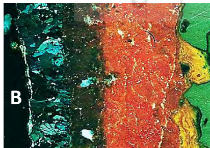
تصویر ۱۱. A: تصویر میکروسکوپ نوری؛ B: تصویر میکروسکوپ نوری؛ C: تصویر میکروسکوپ روبش الکترون از لایه اکسیدی قرمز مس در نمونه ۱۱ (مأخذ: نگارندگان، ۱۳۸۲).
