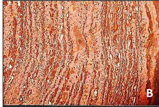
تصویر ۷. A: تصویر نمونه ۷؛ B: تصویر میکروسکوپ نوری از ساختار لایه‌ای از اکسیدهای مس و قلع در نمونه ۷ (مأخذ: علی‌میرزایی، نگارندگان، ۱۳۸۸).
