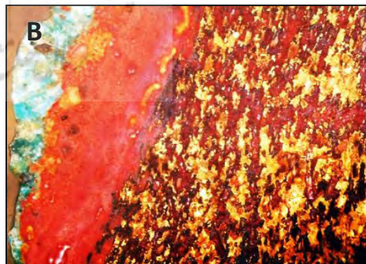
تصویر ۲. A: تصویر نمونه ۲؛ B: تصویر میکروسکوپ نوری از پیشرفت تشکیل ترکیبات اکسیدی مس در مرزخانه‌ها (مأخذ: نگارندگان، ۱۳۸۹).
