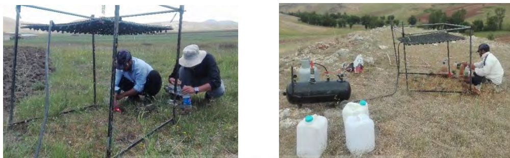
شکل (۲) تصاویری از نحوه‌ی برداشت نمونه‌های رواناب و رسوب در عرصه با استفاده از شبیه‌ساز باران Fig (2) Images of field runoff and sediment sampling using rain simulator
