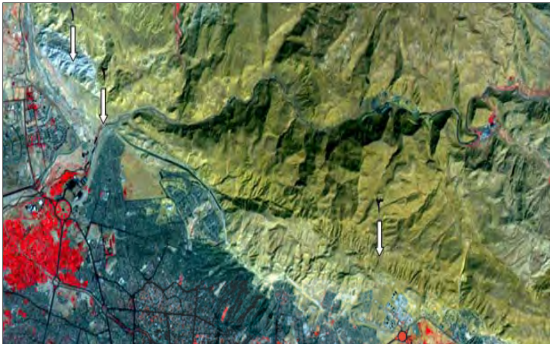
شکل (۱۱) بزرگ‌نمایی برخی شواهد تکتونیکی گسل تبریز بر روی تصویر رنگی؛ در این شکل، ۱. پدیده‌ی عدسی شکل، ۲. انحراف آبراهه‌ی آجی‌جای، ۳. پرتگاه گسل
