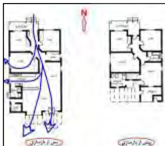
شکل ۱۱. نقش دیوارهای داخلی در کانالیزه کردن باد
