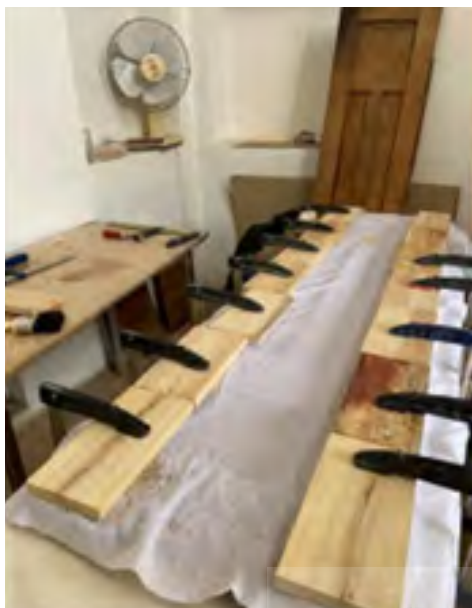
شکل ۱۷. بستن اثر توسط گیره پس از زدن محلول تاب‌گیری در جهت مخالف بخش تاب‌گرفته
