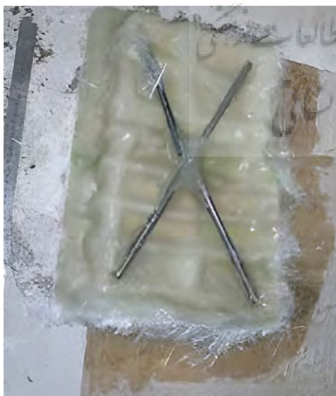
شکل ۱۰. پس‌قالب فایبرگلاس با سازه فلزی به‌صورت ضربدری
