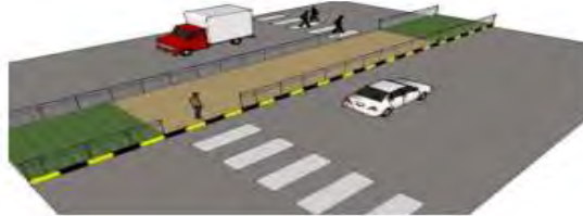
شکل ۵- احداث خطکشیهای پلکانی
