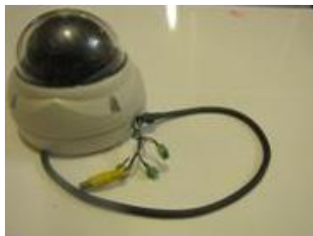
شکل ۱: دوربین dome با قابلیت pan & tilt
