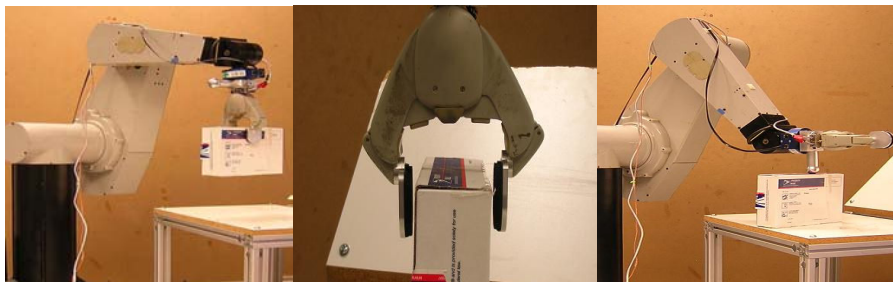
شکل ۵: روبات طراحی شده با ۶ درجه آزادی
