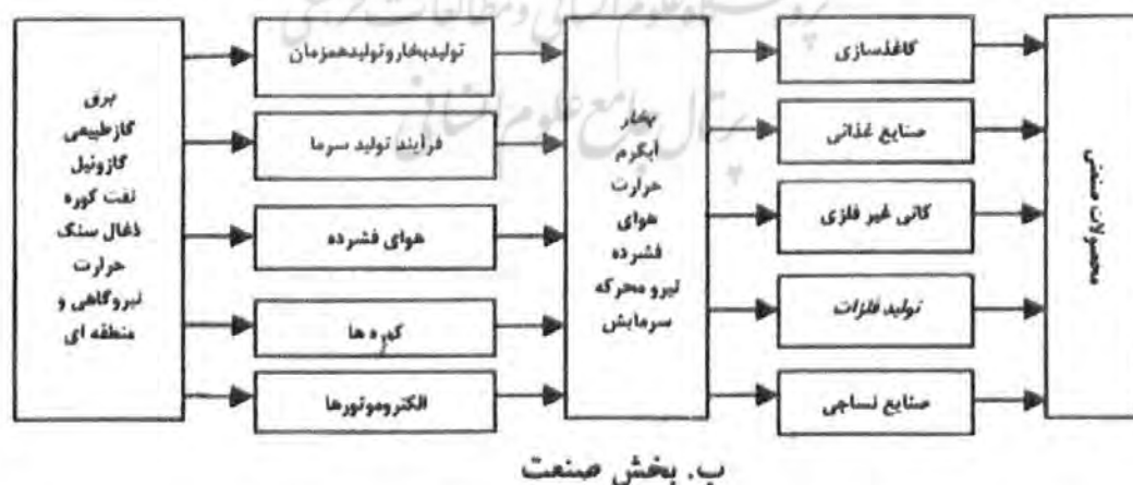
شکل ۱. ساختار شبکه جریان انرژی بخش‌های ساختمان و صنعت کشور
