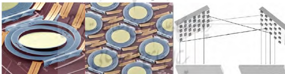
شکل ۱۳: یک نمونه سوئیچ اپتیکی سه بُعدی به همراه طرح‌واره‌ای از آن (Yeow et al., 2001)
