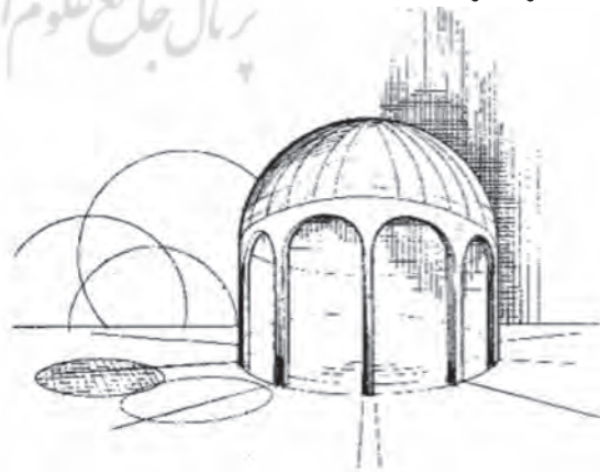
تصویر ۳۷. نمونه یک گنبد با پلان دایره و تصویر ۳۸. (سمت چپ) ساخت پوسته با استفاده از مربع؛ ماخذ: نگارنده.
