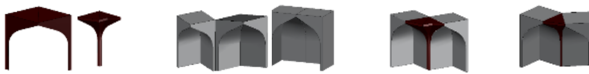
شکل ۱۶: به ترتیب از راست به چپ: اتصال دو المان پرکننده با المان میانی، اتصال یک المان پرکننده با یک المان میانی توسط المان میانی، اتصال دو المان پرکننده بدون المان میانی، اتصال دو المان میانی به هم (Authors 2023)
