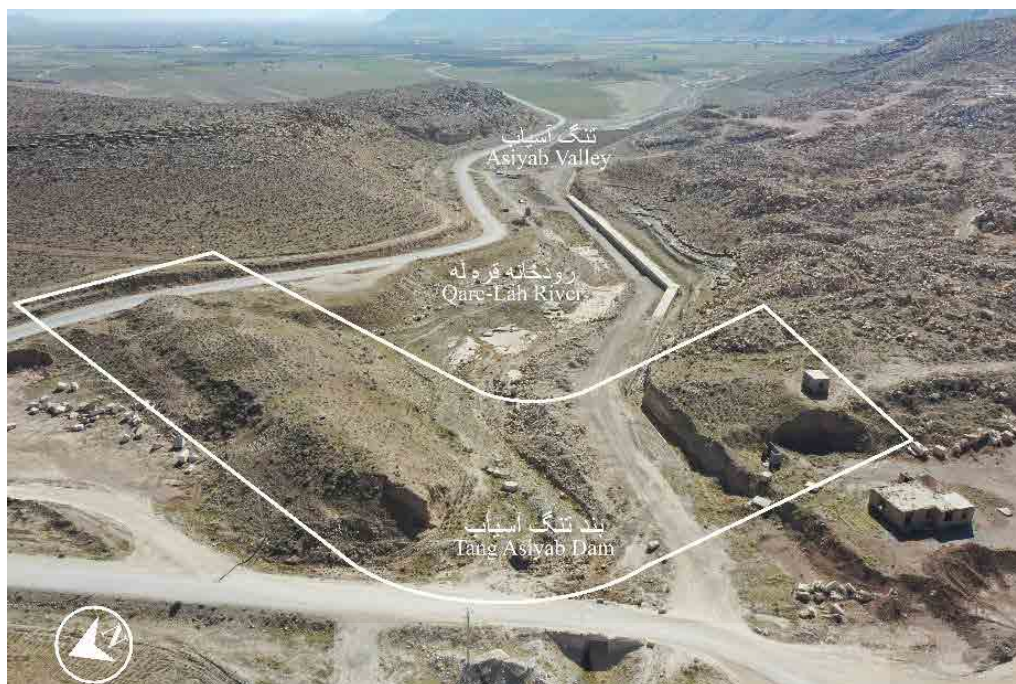
شکل ۱۸. دید هوایی بند تنگ آسیاب و شکل کمانی آن (نگارندگان، ۱۳۹۹).
