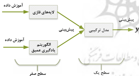
نگاره ۲: ساختار ترکیب یادگیری عمیق و سیستم فازی به روش Stacking
