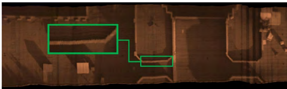
شکل ۳. تصویر اصلاح شده با استفاده از نرم افزار CubeCreator. بخشی از اعوجاجات باقی مانده در سطح تصویر اصلاح شده بزرگ نمایی شده است
