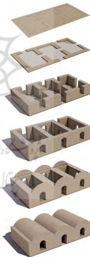
ت 10. مراحل اجرای خانه با تاق ضربی.
