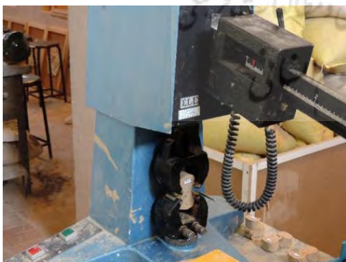
ت ۱۳. تعیین مقاومت کششی نمونه‌ها با بریکت. مأخذ: نگارنده.
