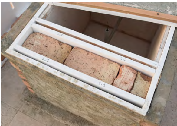
تصویر ۷- نمایش عایق‌های جانبی جابه‌جا شونده دیوار اصلی.
