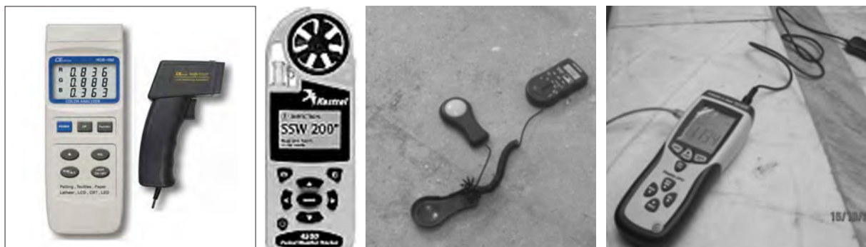
تصویر ۴- دستگاه های اندازه گیری دما و نور، به ترتیب از راست به چپ: نورسنج دیجیتال ۵ ، نورسنج دستی، دستگاه هواشناسی کستزل، دستگاه آنالیز رنگ.
