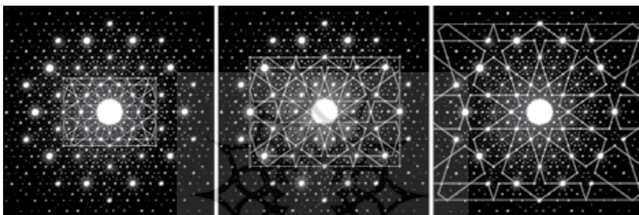
تصویر ۱۸- انطباق گره تند دو پنج در سه مقیاس مختلف بر تصویر پراش پراگ از آلیاژ AL_{70}Ni_{15}Co_{15} .
