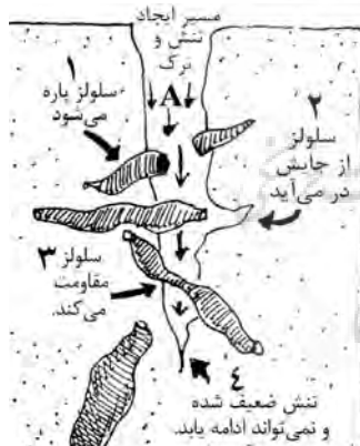
تصویر ۵- مکانیزم مقاومت الیاف سلولز در برابر ترک خوردن. ماخذ: (Gault, 2008, 85)
