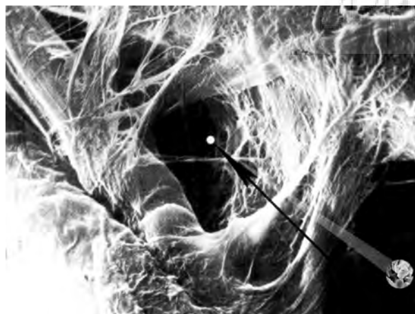
تصویر ۳- تصویر میکروسکوپی الیاف سلولز. در نقطه‌ی سفید وسط تصویر میلیون‌ها ذره‌ی رس می‌توانند قرار گیرند. ماخذ: (Gault, 2008, 80)
