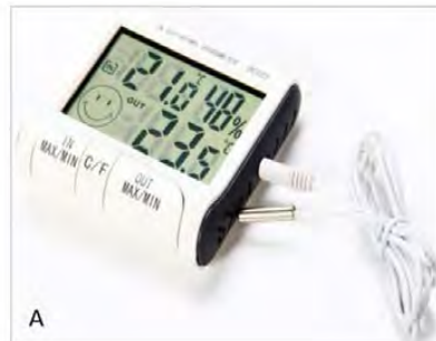
تصویر ۲: دستگاه‌های مورد استفاده برای اندازه‌گیری (A) دما و رطوبت (مدل DC103) و (B) سرعت جریان هوا (فلومتر AR816)
