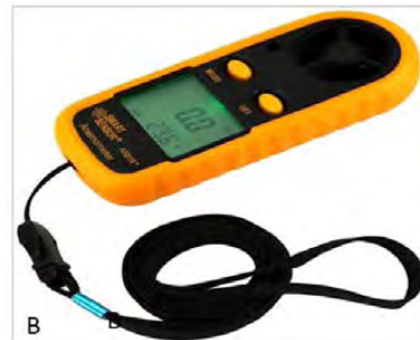
تصویر ۲: دستگاه‌های مورد استفاده برای اندازه‌گیری (A) دما و رطوبت (مدل DC103) و (B) سرعت جریان هوا (فلومتر AR816)
