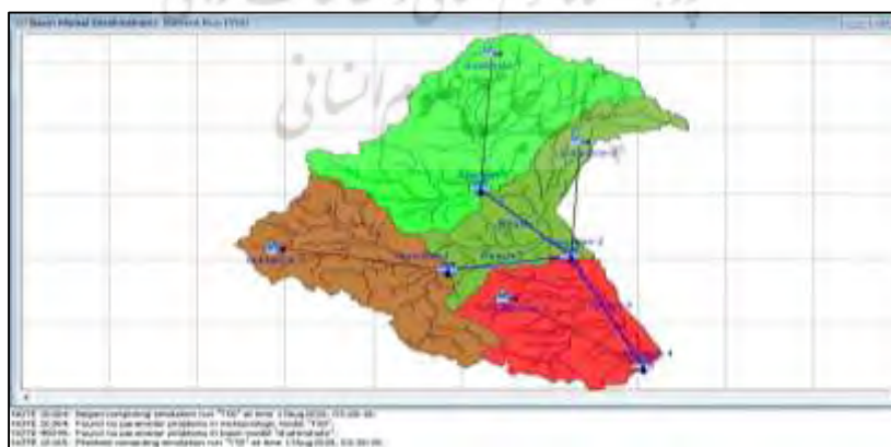
شکل ۸- شماتیک تعیین حداکثر دبی عبوری مسیل شاهین شهر بر اساس حداکثر دبی خروجی هر یک از زیر حوضه‌ها
