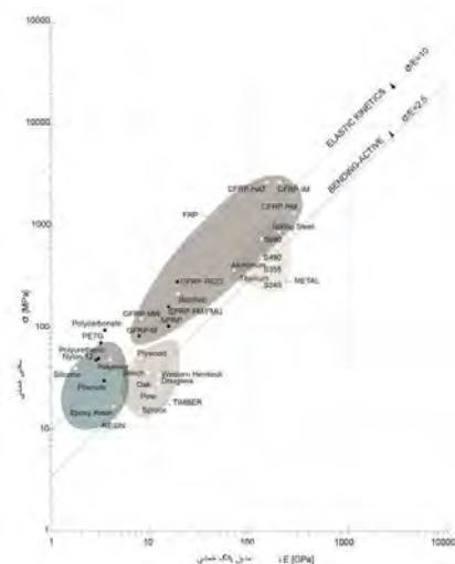
کل ۹- نمودار اشیبی با مقایسه مصالح مناسب و نامناسب سازه های خمشی فعال (مأخذ: لینهارد و نیپر، ۲۰۱۴)
