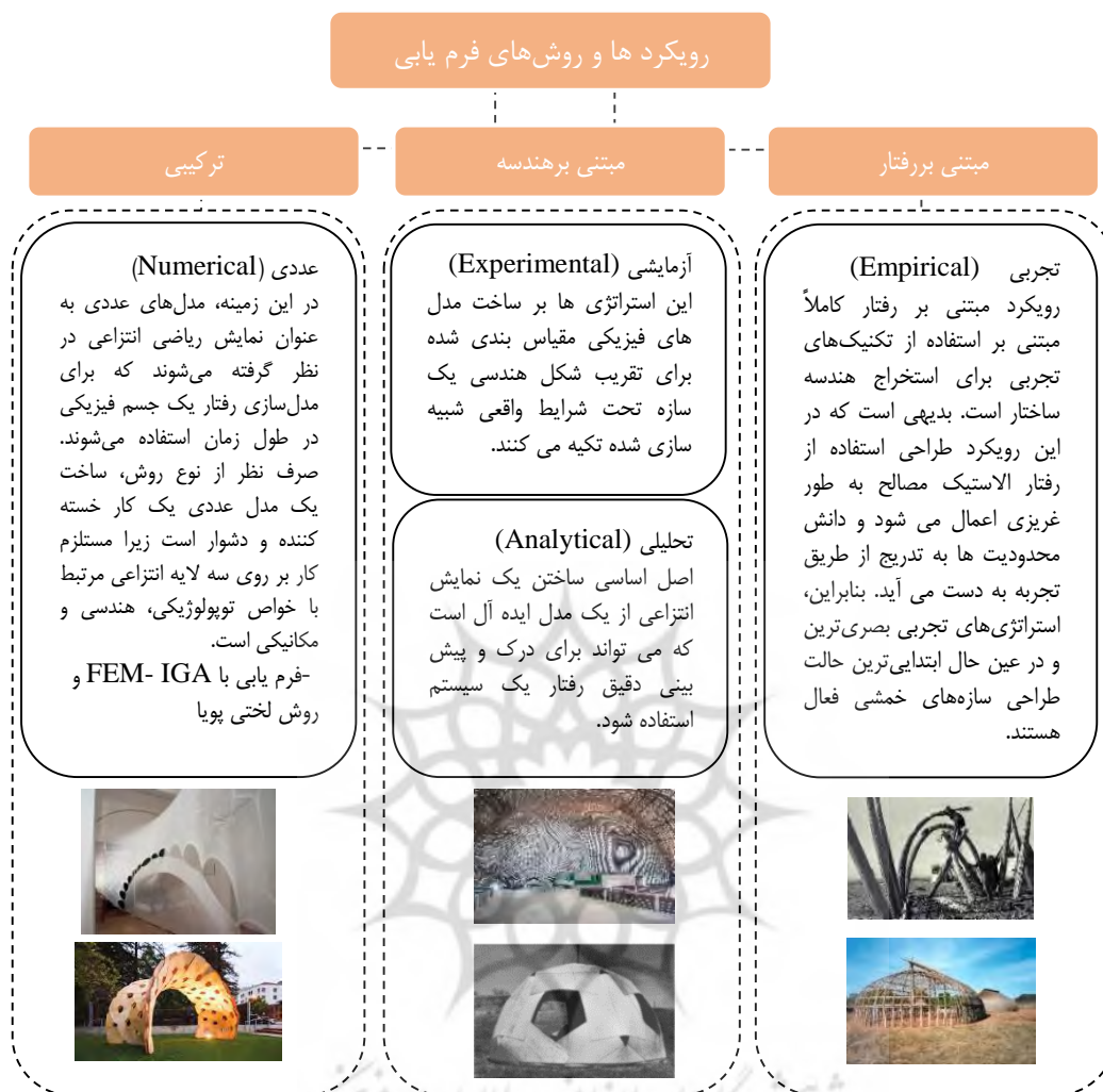
شکل ۴- جمع بندی رویکردها و روش های فرم یابی سازه های خمشی فعال (مأخذ: جمع اوری نگارنده)
