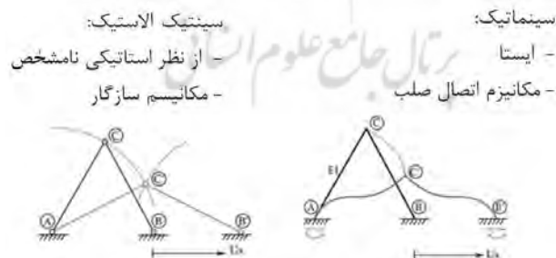
شکل ۷- (چپ) تغییر شکل مکانیزم صلب سینماتیکی. (راست) تغییر شکل مکانیسم سازگار (مأخذ: لینهارد و نیپر، ۲۰۱۴)
