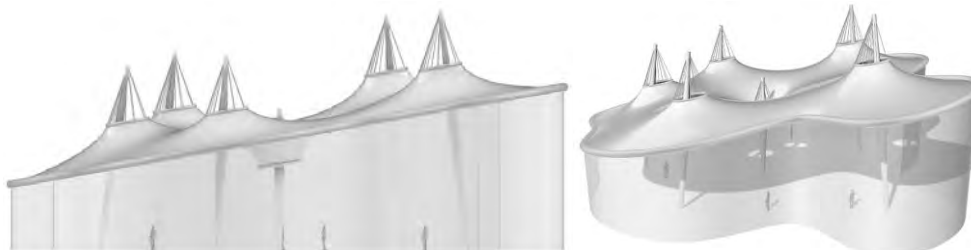
شکل ۷- فرم نهایی غشایی فرم آزاد پس از فرم یابی و بهینه سازی معماری (مأخذ: نگارندگان، ۱۴۰۰)
