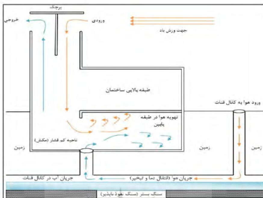
شکل ۱. نحوه عملکرد بادگیر (جهانگیری و زارع، ۱۳۹۳)
