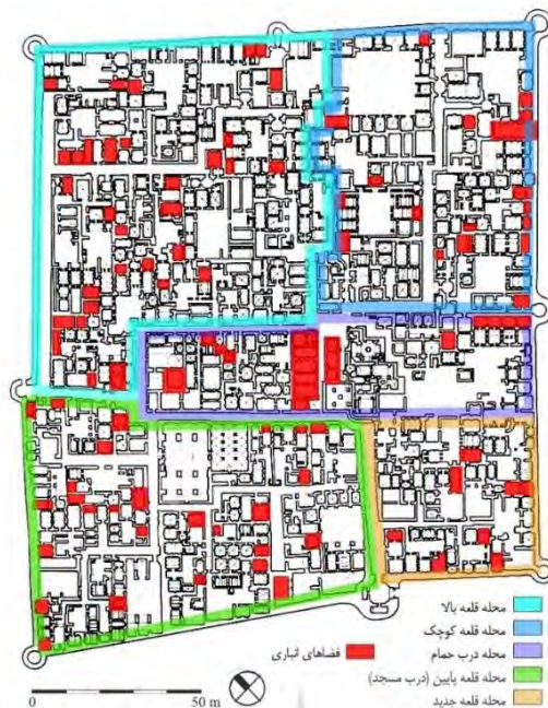
تصویر ۸: توزیع فضاهای انبار و ذخیره‌سازی در قلعه تاریخی مورچه‌خورت به تفکیک محلات پنج‌گانه (مأخذ: نگارنده اول، ۱۴۰۰؛ بازطراحی بر اساس منوچهری، ۱۳۸۷: ۴۷)
