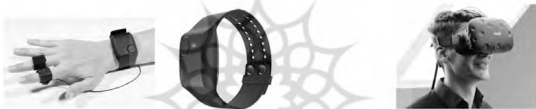
تصویر ۵- سمت راست؛ هدست واقعیت مجازی Tobii Pro VR Integration که قابلیت ردیابی حرکت سر و چشم (Head and Eye tracking) را دارد ( www.tobii.com ). سمت چپ؛ ابزار Empatica E4 wristband که سطح هدایت پوستی (Skin Conductance) و ضربان قلب را ارزیابی می‌نماید ( www.empatica.com ).
