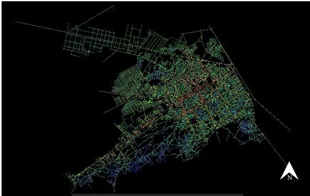
تصویر ۱۲- گراف نمایه انسجام کلان کل محدوده شهری کاشان در دهه ۱۳۹۰؛ هر چه رنگ خطوط به سمت آبی (طیف سرد) متمایل شود از مقدار انسجام کاسته می‌شود و بالعکس با متمایل شدن خطوط به سمت رنگ قرمز (طیف گرم) به میزان انسجام آن‌ها افزوده می‌شود (مأخذ: نگارندگان).
