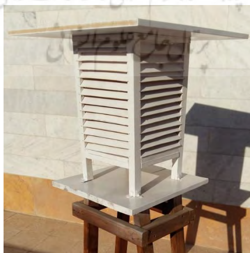
تصویر ۸- جعبه استیونسن محل قرارگیری دستگاه دما و رطوبت سنج محیطی (ماخذ: نگارندگان، ۱۳۹۸)
