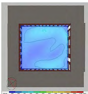
تصویر ۸- خروجی کانتور سرعت از محاسبات CFD در نرم‌افزار دیزاین بیلدر - حیاط خانه طالبان فرد (ماخذ: نگارندگان)
