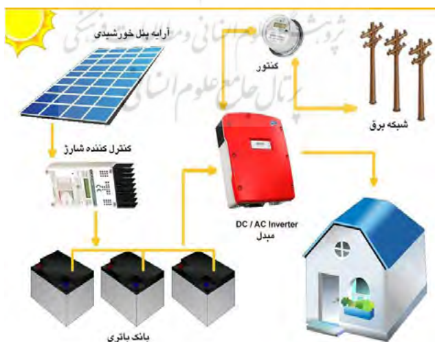
شکل (۲): اجزای یک نظام مرتبط با شبکه با باتری پشتیبان (Farzanegan Caspian Co., 2015)
