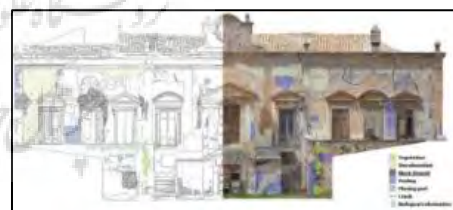
شکل ۱۴: نقشه آسیب‌های قابل توجه در نمای جنوب شرقی Fig14: Map of significant damage in the southeast view
