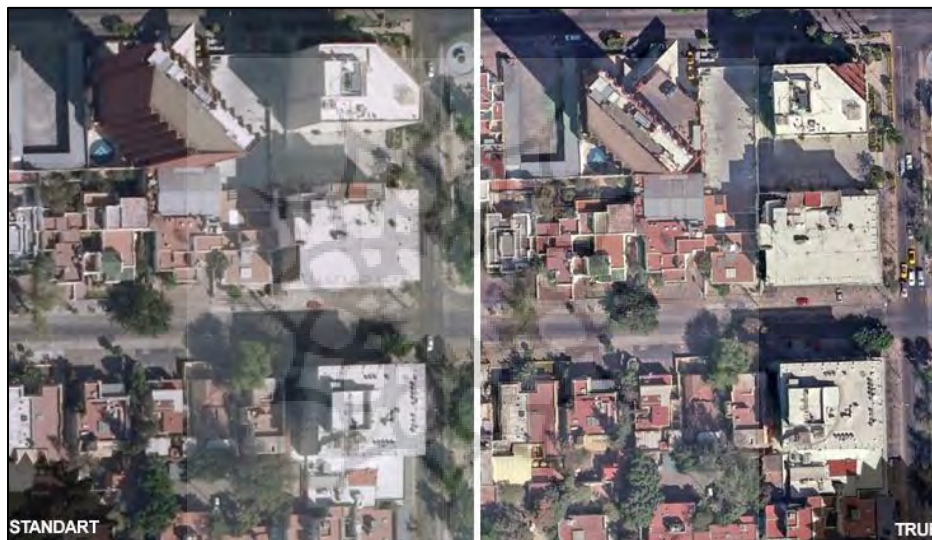
شکل ۳: مقایسه اورتوفوتوموزائیک و اورتوفوتوموزائیک حقیقی Fig. 3: Comparison of ortho-photomosaic and true ortho-photomosaic
