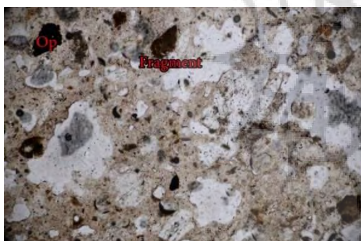
شکل ۲۸: وجود کانی اپک، بزرگنمایی ۱۰۰ حالت PPL Figure 28: the presence of Mineral Op, 100x, PPL mode
