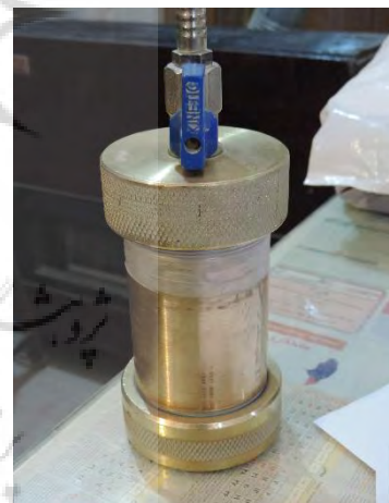
شکل ۷: دستگاه اندازه‌گیری میزان نفوذپذیری در مقابل آب Fig. 5: Water permeability measuring device
