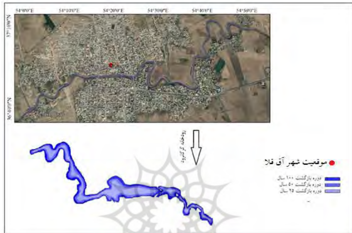
شکل ۶: پهنه بندی سیلاب در دوره بازگشت‌های مختلف با استفاده از نرم افزار HEC-RAS
