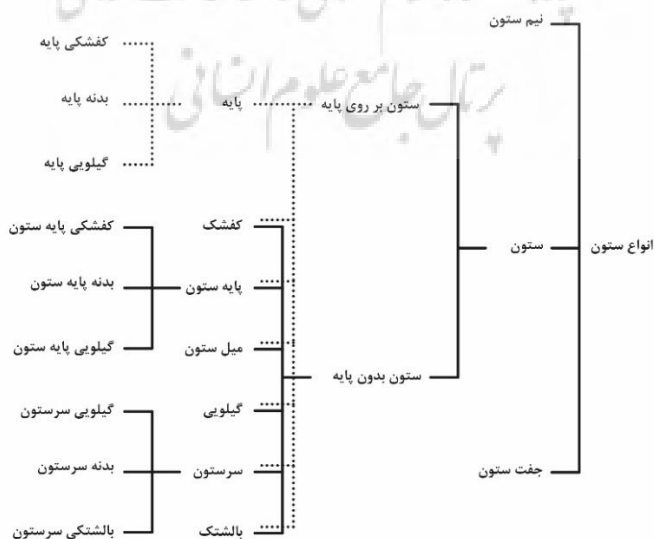
شکل ۷. مدل مفهومی انواع ستون و اجزای آن.
