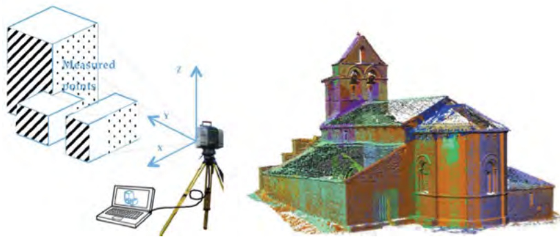
شکل ۱. جمع‌آوری داده به روش اسکن لیزری
