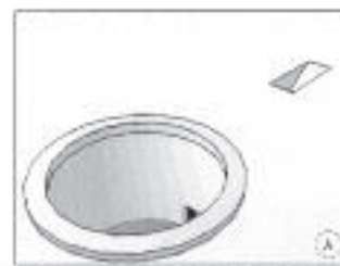
ساخت سکوی آجری زیر گنبد
