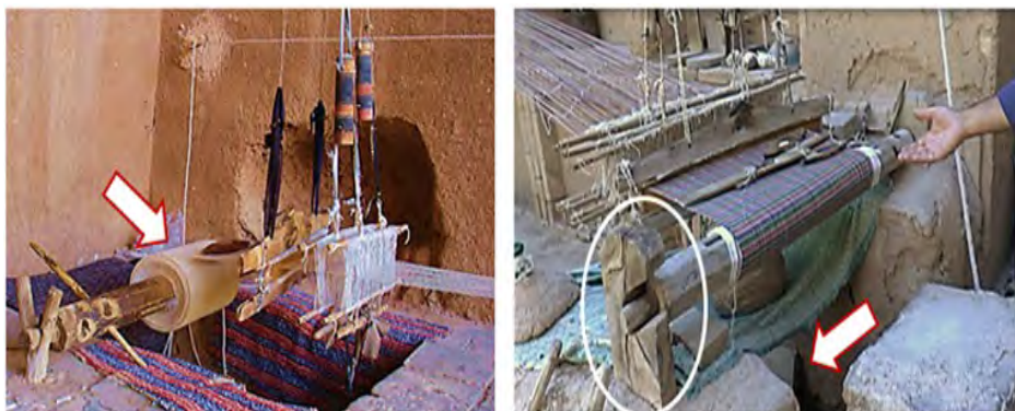
عکس‌های ۵- دستگاه کار و چاله به همراه نمونه پارچه بافته شده؛ فلش‌ها محل قرارگیری پاهای بافنده را در چاله نشان می‌دهند
