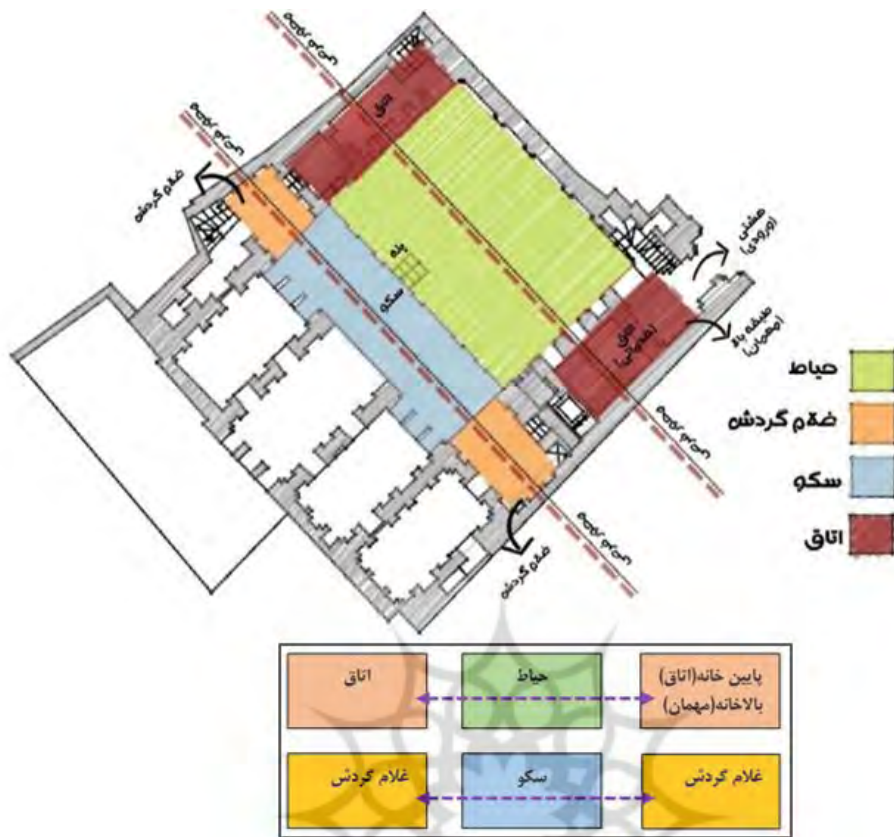
شکل ۱۶. نمایش فضاهای فرعی بر روی محور فرعی - پلان خانه امین زاده شوستر
