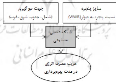
شکل ۴. ورودی‌ها و خروجی ساختار شبکه‌عصبی مصنوعی توسعه داده‌شده در این پژوهش
