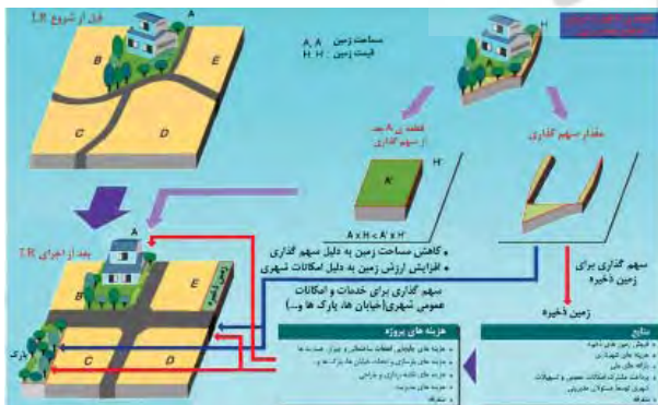
شکل ۱. نمایی از روش اصلاح مجدد زمین و چگونگی انجام آن
