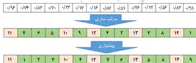
شکل ۳. نحوه تبدیل یک رشته اعداد اعشاری به جواب مسئله برای تخصیص فعالیت به ایستگاه کاری
